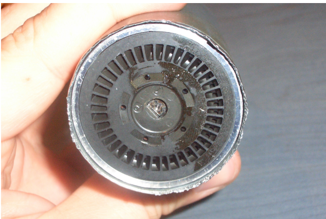
Bild 3: Pumpe nach dem Öffnen
