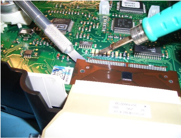
Bild 8: Arbeiten mit Entlötlinge
