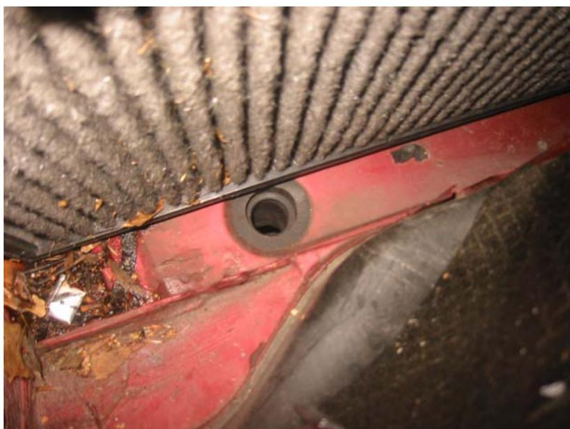
Um an diese Tülle zu kommen, muss man übrigens das Motorsteuergerät herausnehmen. Das befindet sich in dem schwarzen Kasten vor dem Pollenfilter. Der Kasten ist in einer Schiene und lässt sich deshalb einfach nach oben herausziehen. Die Kabel sind alle lang genug dafür und passieren tut dort auch nichts. Später beim Einbau sollte man darauf achten, dass das Motorsteuergerät auch wieder wirklich richtig in der Schiene sitzt, sonst gibt es nachher unerwünschtes klappern.
