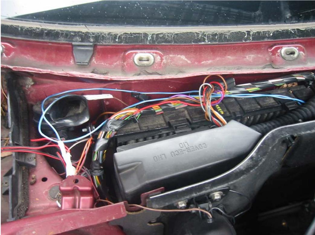
Indem man mit einem Finger in die Tülle geht, kann man sie vollständig herausziehen. Jetzt kann man auch den Doppelboden erkennen und ungefähr den Zweck, den diese Tüllen erfüllen sollen. Nehmt also die Tülle und schneidet mit einem Messer den kompletten unteren Teil ab. Also den Teil, der konisch zuläuft und immer enger wird. (Hab leider kein Bild von einer original Tülle. Wer eines hat, kann es mir ja zusenden ;-)) Hier auf dem Bild ist die Tülle bereits abgeschnitten)
