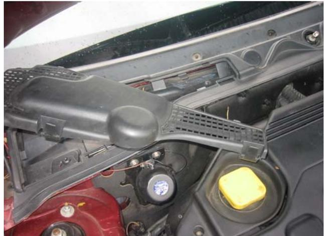
Unter beiden Deckeln befindet sich jeweils eine Art „Schraubniete“. Dort die Schraube mit einem Schraubendreher herausdrehen und die Hülse, in der die Schraube gedreht war, ebenfalls herausnehmen.
