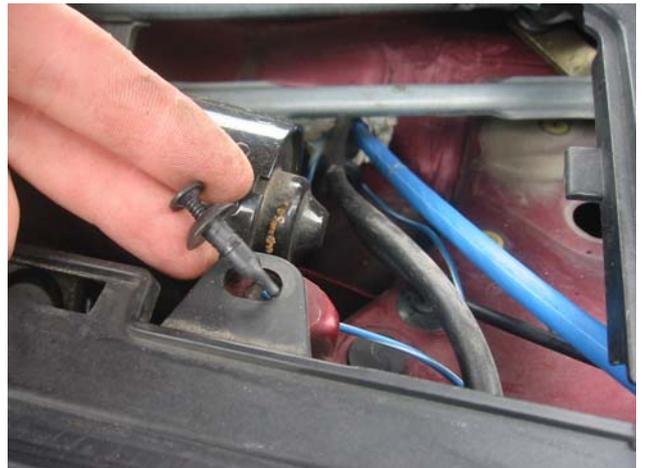
Danach löst man noch die Halterung für den Wasserschlauch der Schreibenwaschdüsen, da man ja genau das Kunststoffteil abnehmen möchte, an dem die Halterung befestigt ist. Diese Halterung mit dem Schlauch findet man ganz oben links an dem Gelenk, an dem die Motorhaube befestigt ist.
